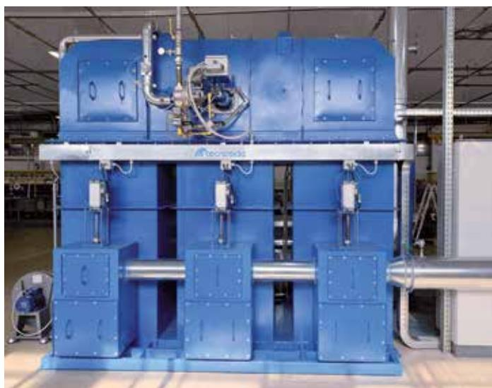
Utilizzati per l'ossidazione ad alte temperature dei Composti Organici Volatili (COV), COV alogenati e altre sostanze che possono essere bruciate.
