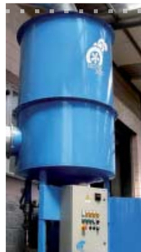
DEPURAZIONE FUMI DERIVANTI DA SCARTI DI FALEGNAMERIA
