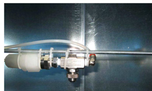
L'ugello spruzzatore all'interno della tubazione di scarico e particolare di collegamento
